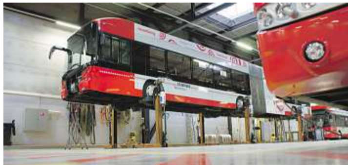
Die Mechaniker müssen im Provisorium ohne Arbeitsgrube auskommen. Für Arbeiten unter dem Fahrzeug wird dieses angehoben.
