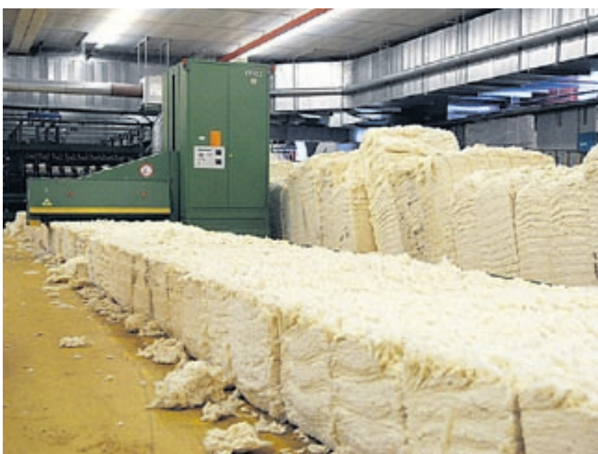
Den ersten Arbeitsschritt erledigt der «Unifloc». Er saugt die Baumwollfasern ein.
